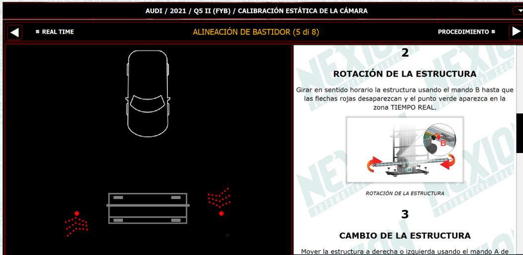
Posicionamiento rápido del sistema a través de información comunicada en tiempo real en el software por los diferentes punteros láser. Las medidas se comunican a través de Bluetooth y se controlan por software; esto permite conocer en todo momento la posición del sistema y evitar errores. Operador operativo inmediatamente.
